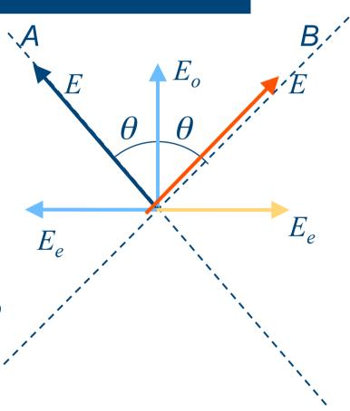
A placa de ¼ de onda é aquela na qual a diferença de fase obtida entre as duas componentes é ¼ do período, ou seja, π/2.
