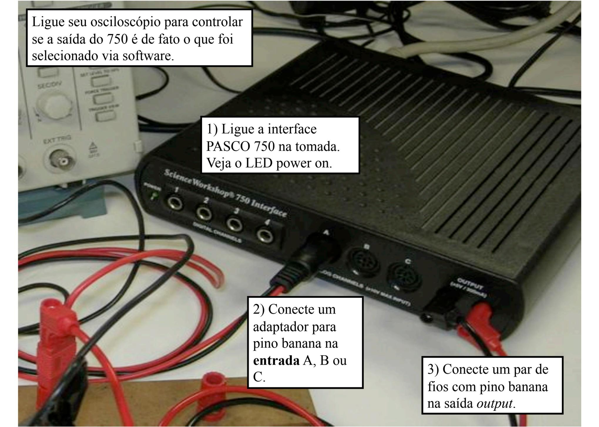
Ligue seu osciloscópio para controlar se a saída do 750 é de fato o que foi selecionado via software.
