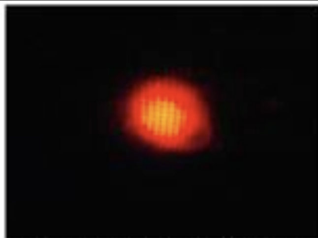
Figura 5 – Transformada Inversa da grade quadriculada depois de passar por um orif
