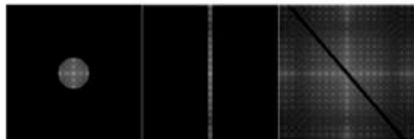
Figura 8: Modificações feitas nas transformadas para obter as imagens simuladas. Procurou-se retirar as mesmas frequências que os filtros retiravam
