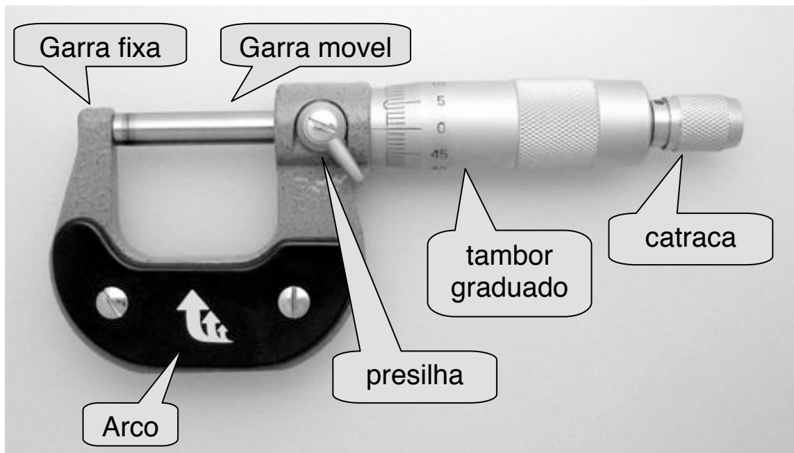
Figura 3.1. Micrômetro padrão similar aos utilizados no laboratório didático.
