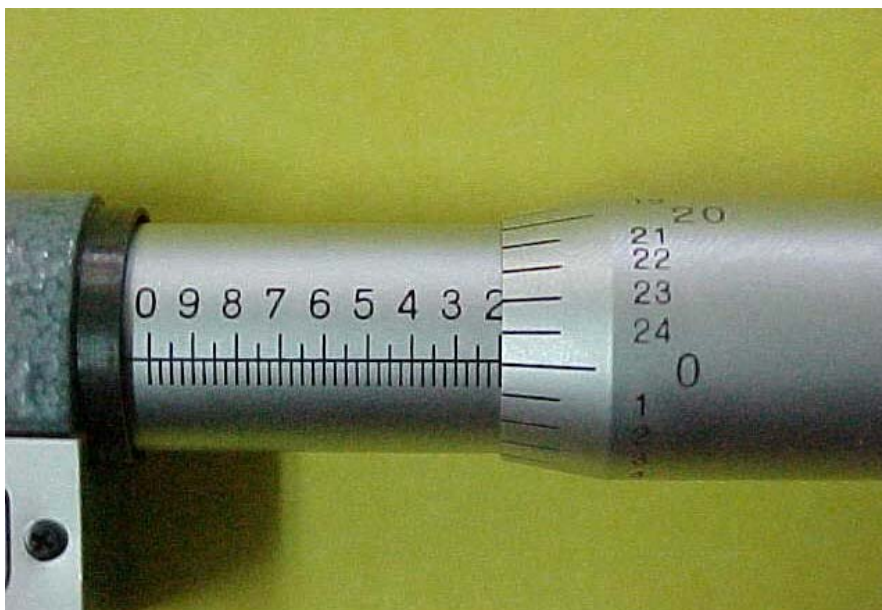
Figura 3.3 – Parafuso micrométrico graduado de um micrômetro simples.
