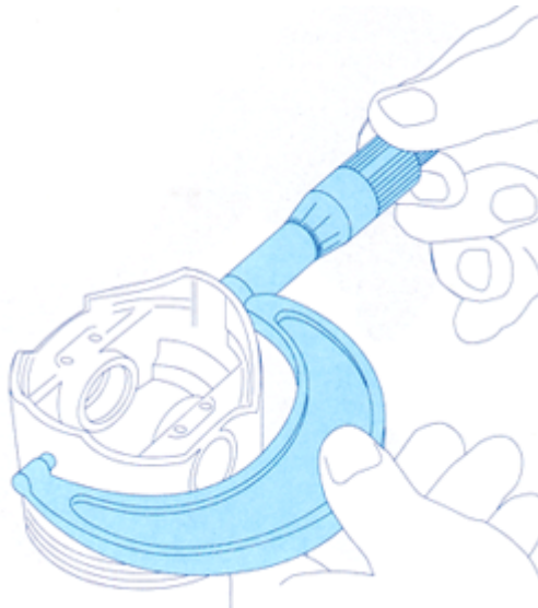
Figura 3.4 – Realizando uma medida com um micrômetro simples.
