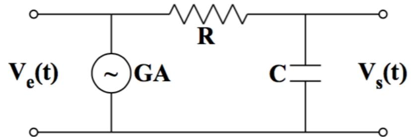
O estudo de um sinal não harmônico em um circuito regido por uma E.D. linear pode ser feito decompondo o sinal nas suas frequências harmônicas e estudando o comportamento deste circuito para cada uma destas componentes!
