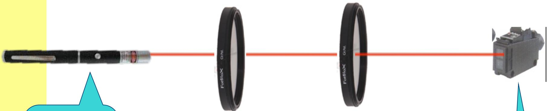
Laser de diodo com regulagem de intensidade
