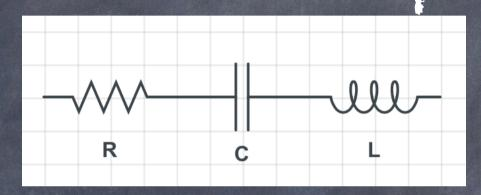
Três elementos em série – mesma corrente. Qual a tensão total?
